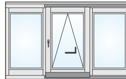
TYP 14 PSK-B Parallel Schiebekipptür einteilig, dreiflügelig
